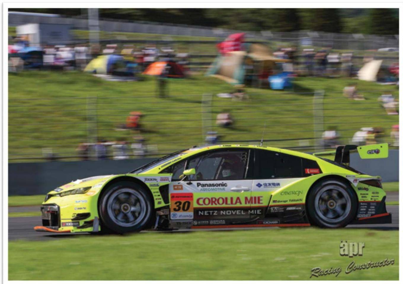
シリーズの折り返しとなるスーパーGT シリーズ第 5 戦が富士スピードウェイを舞台に、「FUJI GT 500MILE RACE」として開催された。今年も apr は引き続き 2 台体制で挑むが、マシンを TOYOTA GR SPORT PRIUS PHV (ZVM52) にスイッチ。規定の変更と合わせ、駆動方式をミッドシップから FR に改め、さらに 5.4L の V8 エンジン、2UR-G を新たに搭載することとなった。「#30 TOYOTA GR SPORT PRIUS PHV apr GT」をドライブするのは、引き続き永井宏明選手と織戸学選手。タイヤもヨコハマが継続して使用される。
